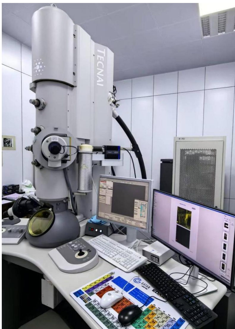
FEI Tecnai G2 F30 高分辨场发射透射电子显微镜+Bruker Nano GmbH(XFlash Detector 7T60-330)能谱
